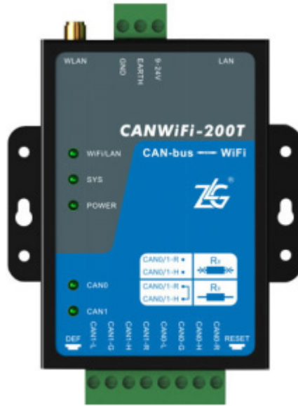
CANWiFi-200T高性能WiFi转CAN模块
