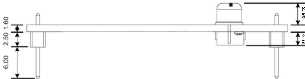
图 1.2 WZNE-1100 模块侧视图及机械尺寸（单位：mm）
