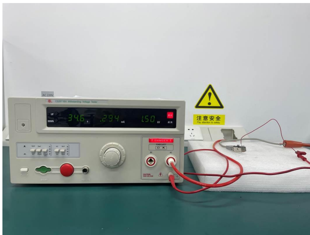
图 7 抗电强度试验
