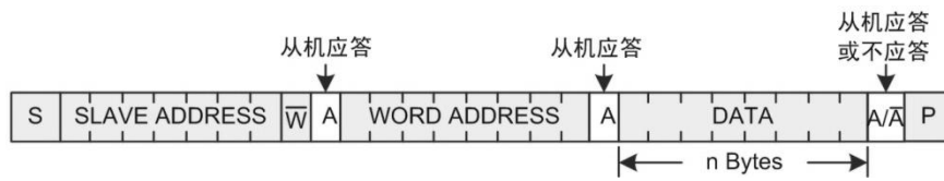
图 3.5 主机向从机发送数据示意图
