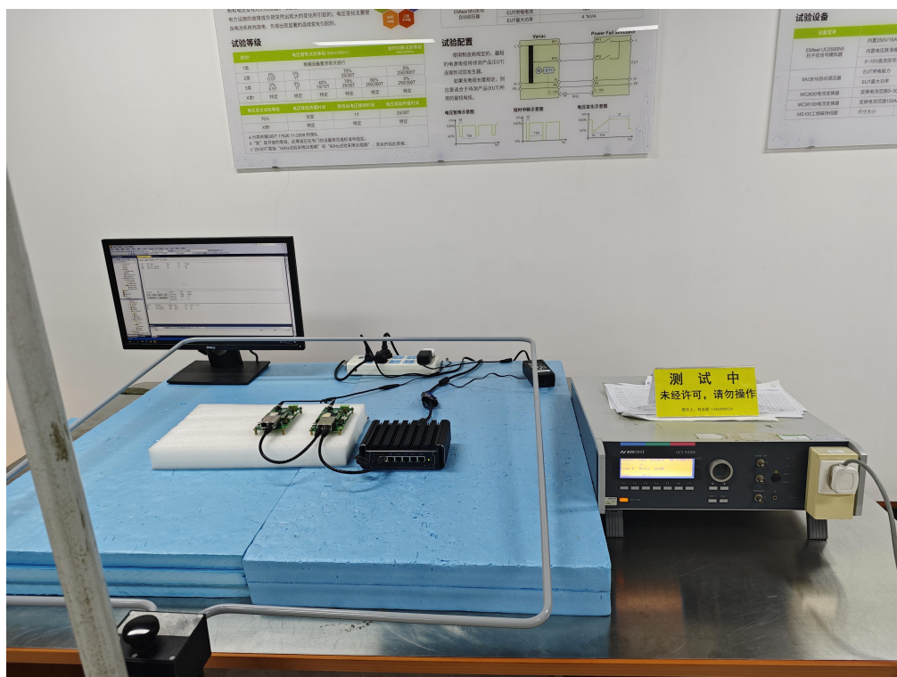
图 5 PFM 试验现场配置图
