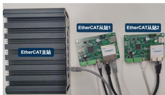
图 12 主从站设备实物连接图
