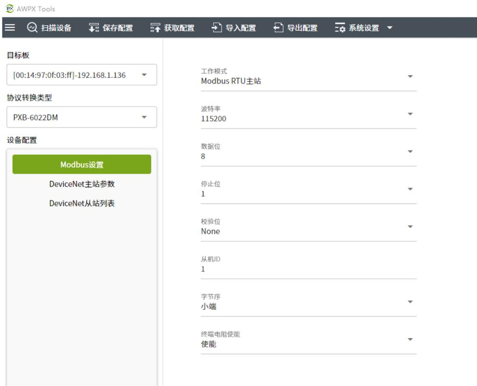
图 3.28 Modbus 参数设置
