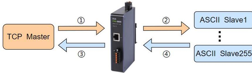
图 3.39 TCP 主站转 ASCII 从站模式的连接示意图
