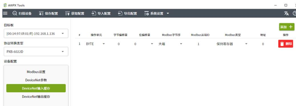
图 3.26 DeviceNet 输入缓存配置界面
