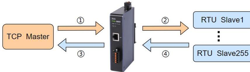
图 3.37 TCP 主站转 Modbus RTU 从站模式的连接示意图
