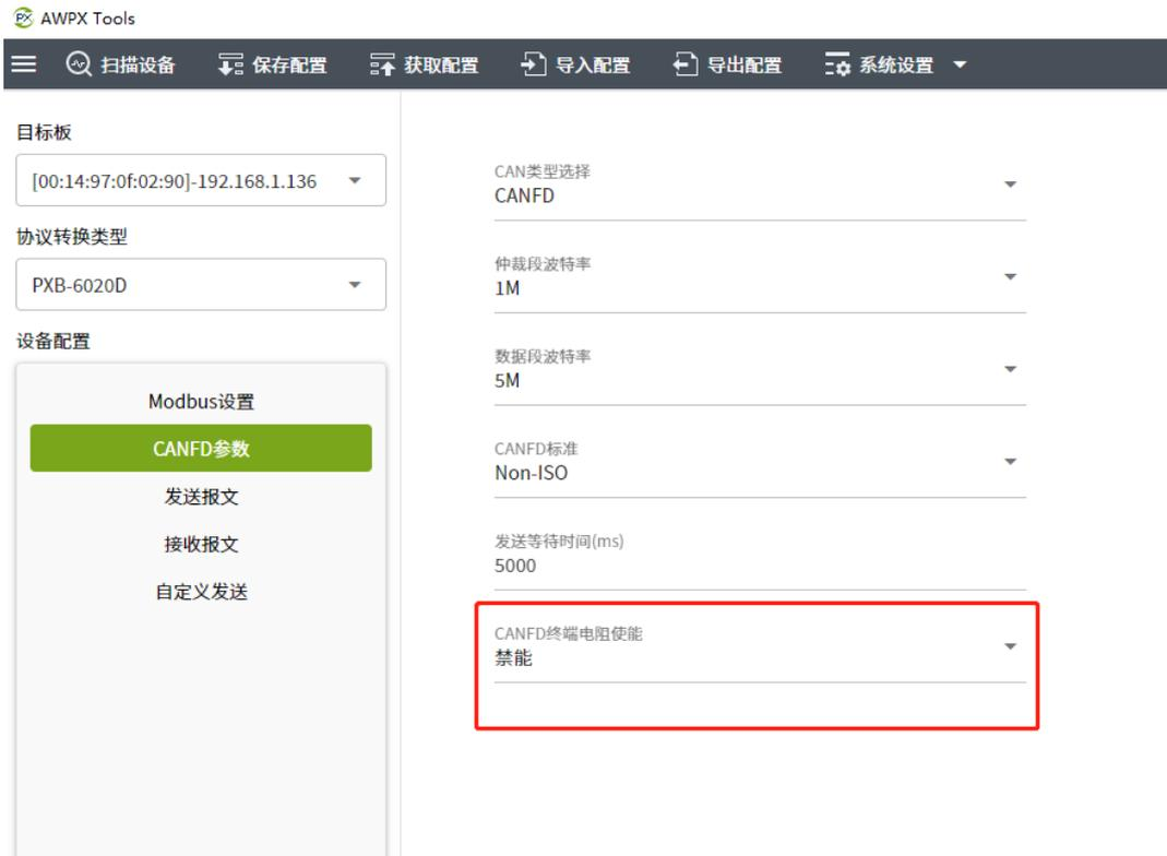
图 2.5 CAN 终端电阻配置
