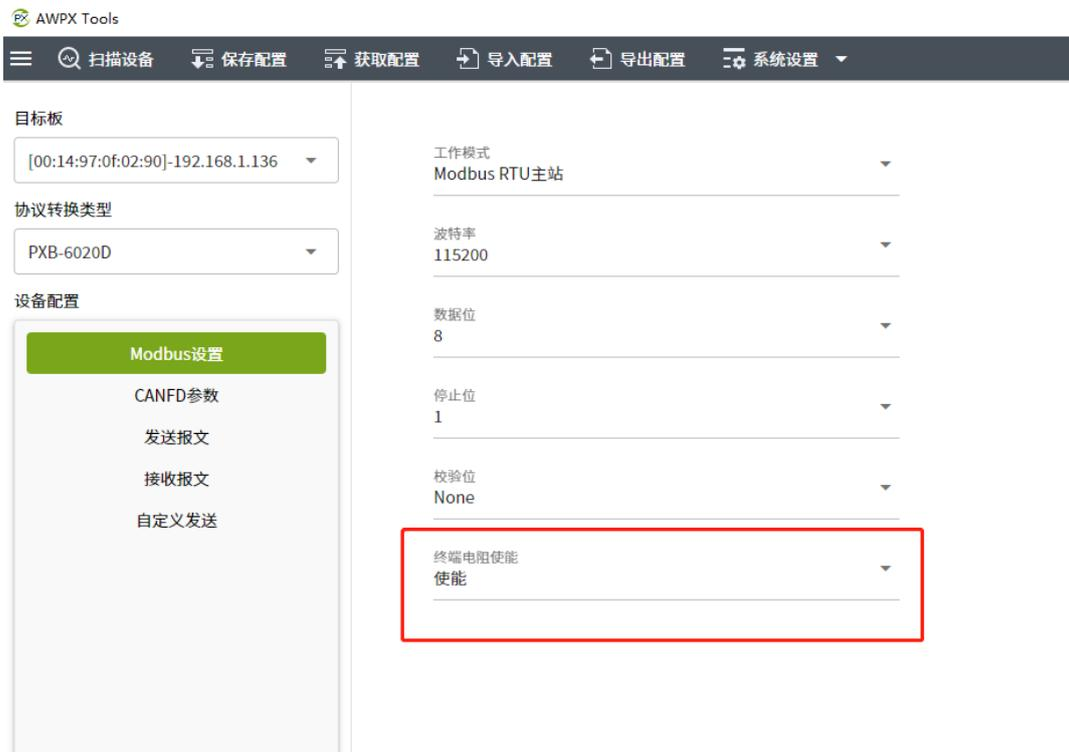
图 2.6 RS485 终端电阻配置
