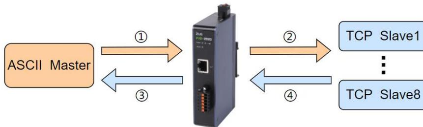
图 3.38 ASCII 主站转 TCP 从站模式的连接示意图
