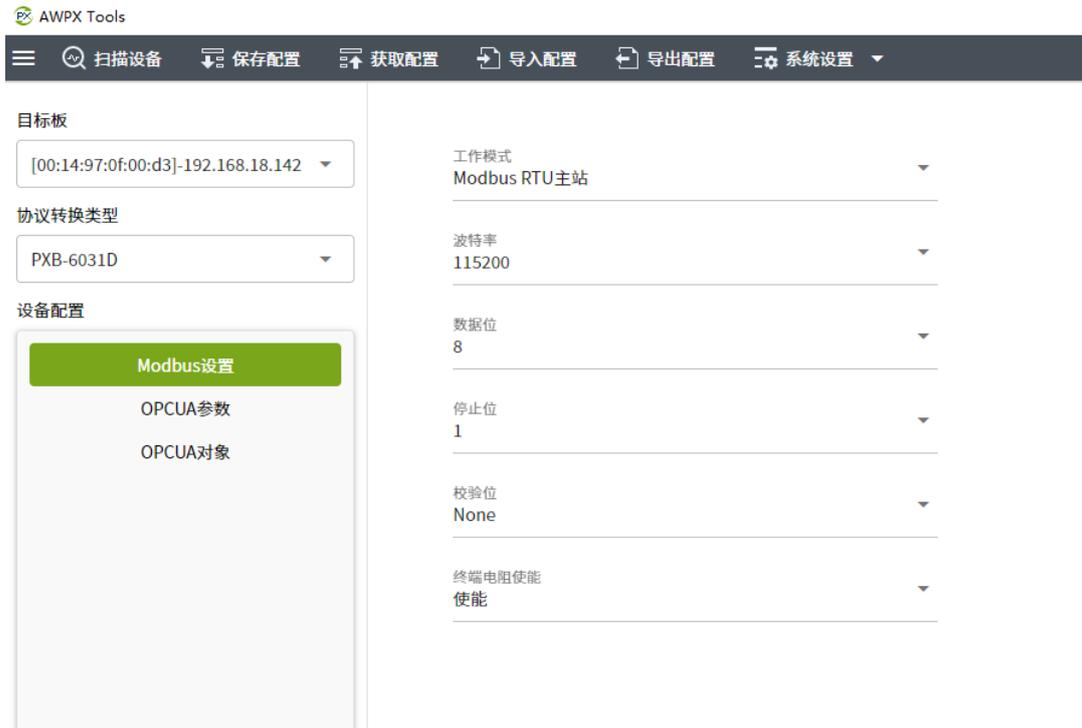
图 3.44 Modbus 参数设置
