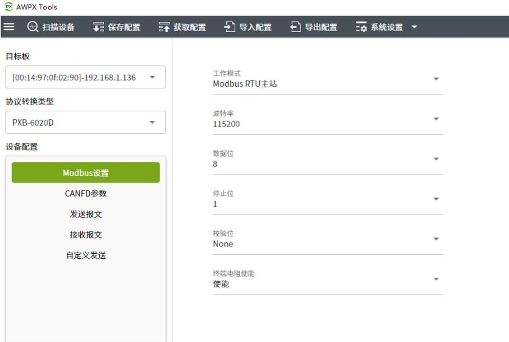
图 3.8 Modbus 参数设置
