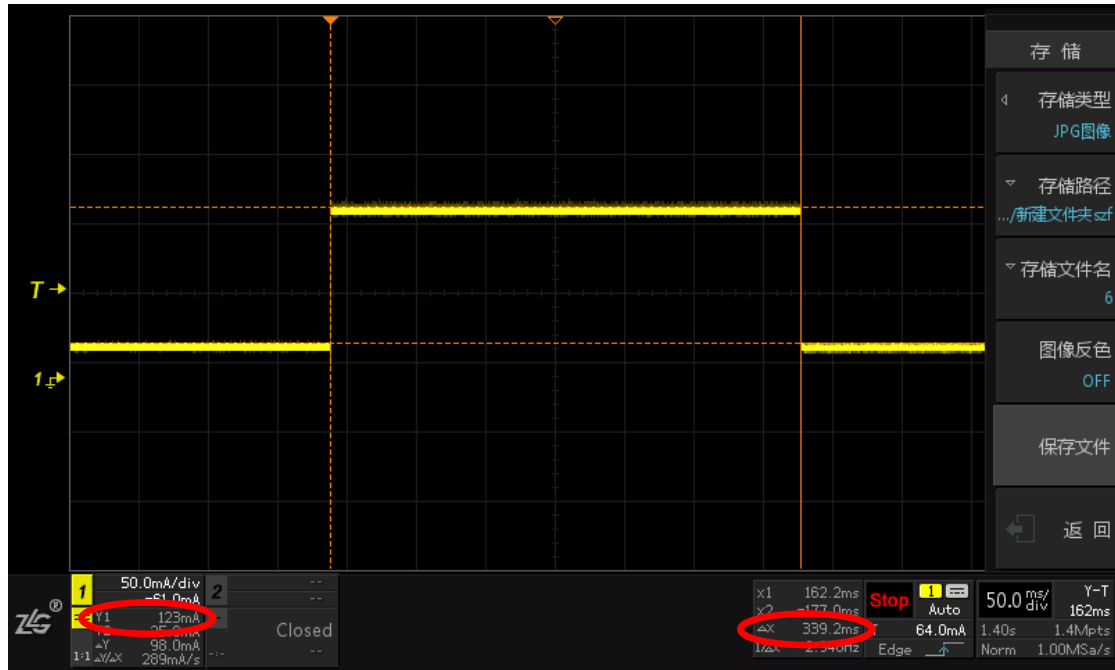
图 2.9 20dBm、速率等级 6 模式下发送 30 字节
