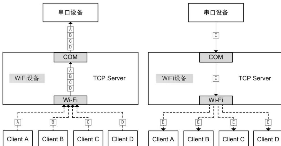
在一些应用场合，需要限制设备可接受的 TCP 个数，比如限制设备最多只允许接入一个 TCP 连接，可以设置【最大连接数目】选项为 1，此时，多余的连接请求将被拒绝。
