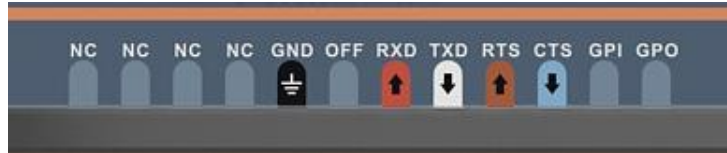
图 2.2 接线端子信号顺序图
