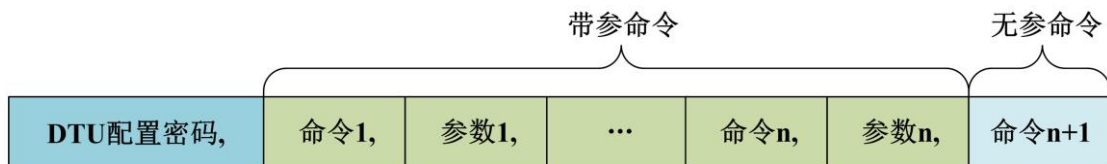
图 3.13 短信配置命令格式
