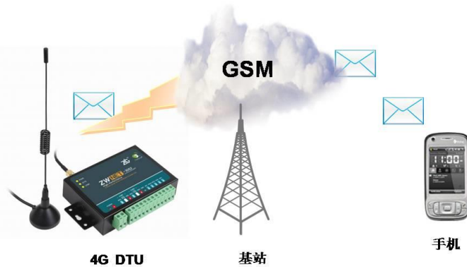
图 3.12 短信配置示意图
